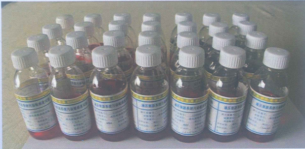
某型液压泵污染敏感度分级实验分析样品
