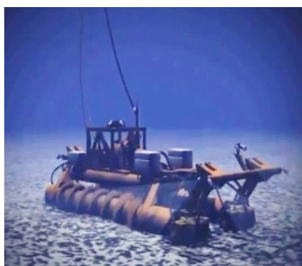
OMA原位采矿 (1978年在东太采集800吨结核)
