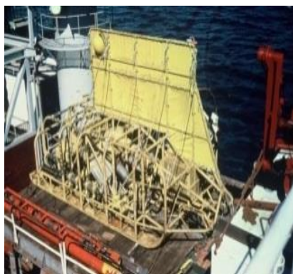
OMA原位采矿 (1978年在东太采集800吨结核)
