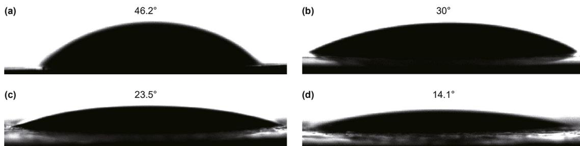
Fig. 7. Contact angle diagram ((a) MMT; (b) CPL-MMT; (c) DODMAC-MMT; (d) (CPL + DODMAC)-MMT).
