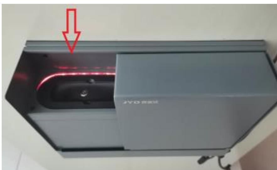
图：无线蓝牙话筒正确的放置位置
