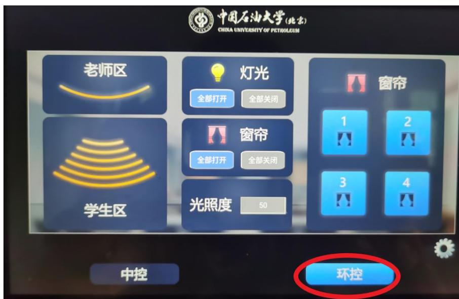
图：液晶控制面的环境控制操作界面
