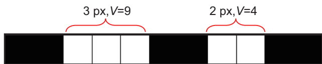
图3 空化云体积计算原理
