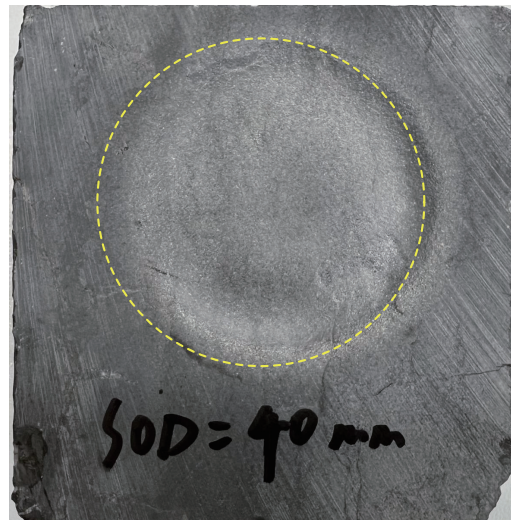
图 13 40 mm 喷射距离下射流成孔形态 Fig. 13 Hole morphology when 40 mm
