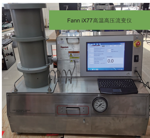
图 4 高温高压流变性测试现场实物图
