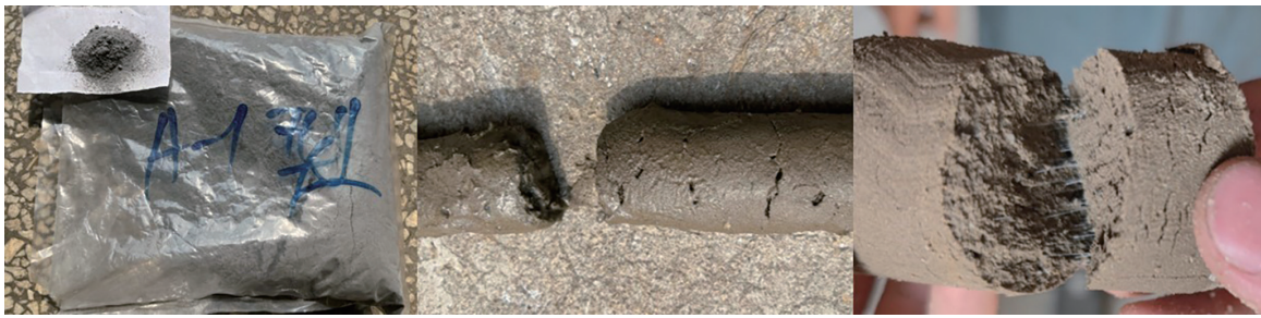
图 11 A-1 型煤粘合剂岩心
